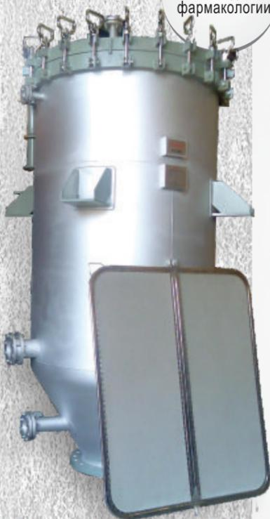
Фильтрация жидкостей с содержанием взвешенных частиц до 7%. Не требуется фильтровальная ткань. Автоматическая очистка фильтра от шлама выполняется с помощью пневматического вибратора или устройства периодической промывки. Возможна выгрузка сухого или влажного осадка. Площадь фильтрации до 142 м<sup>2</sup>.
