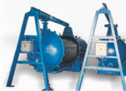
Конструкция с вытягивающимся пакетом пластин
