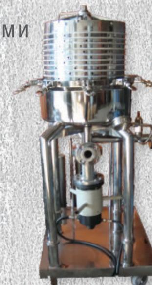
Замкнутые фильтры с горизонтальными пластинами и гидравлической натяжкой
