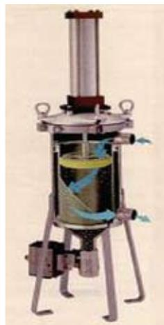
фильтрующего цилиндра и удаляются поступательным движением чистящего диска. Диск приводится в движение пневматически. Твердые частички сбрасываются вниз в концентрированном виде, собираются в конусе корпуса и периодически сбрасываются через клапан очистки (автоматически или вручную). Давление сжатого воздуха, обеспечивающего работу фильтра, от 4 до 6 бар.
