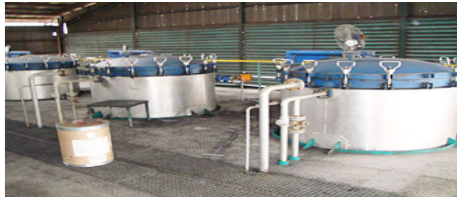
Листовые вертикальные фильтры Sharpflex (3x50м 2 ) на предприятии по производству пищевого масла.
