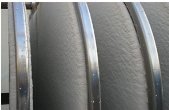
Формирование кека на пластинах горизонтального фильтра Sharpflex
